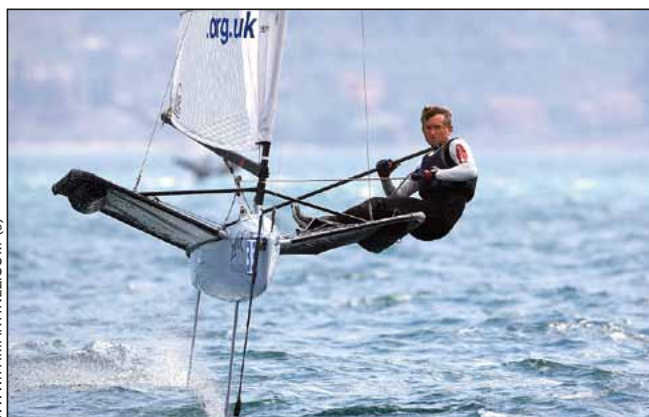
■ Wszystkie moth-y mają układ hydroksrzydeł (mocowanych do pletw: mieczowej i sterowej z wychylnymi klapami) zbliżony do odwróconego „T”
