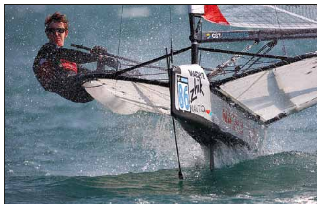
■ Wszystkie moth-y mają układ hydroksrzydeł (mocowanych do pletw: mieczowej i sterowej z wychylnymi klapami) zbliżony do odwróconego „T”
